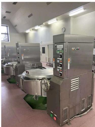
平成18年(センター開設時)に導入した調理用回転釜(7台)について、導入から17年以上が経過したことで、釜を温めるための重要部品(インバーター)の在庫が無くなり修繕ができない状況のため、順次、更新を行う。
