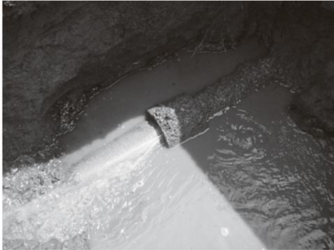
毛呂山町の水道は昭和40年4月に給水を開始して、5回の拡張事業を実施してきており計画給水人口は39,200人・計画一日最大給水量は17,200m<sup>3</sup>/日まで拡大しています。しかしながら水道管の老朽化が進んでおり、町内全体の水道管約200kmのうち、漏水の原因となっている石綿管（ACP管）が約25km（12.7%）残っています。平成23年に発生した東日本大震災で東北・関東地方では水道管破損による断水が多く発生しました。本町でも安全で良質な水道水を届けるために、老朽化した水道管を耐震管へ布設替等の更新整備を計画的に推進しています。
