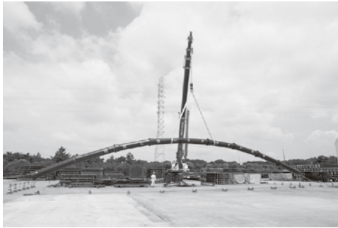
耐震管のダクタイル ちゅうてつ 鉄管NS形
